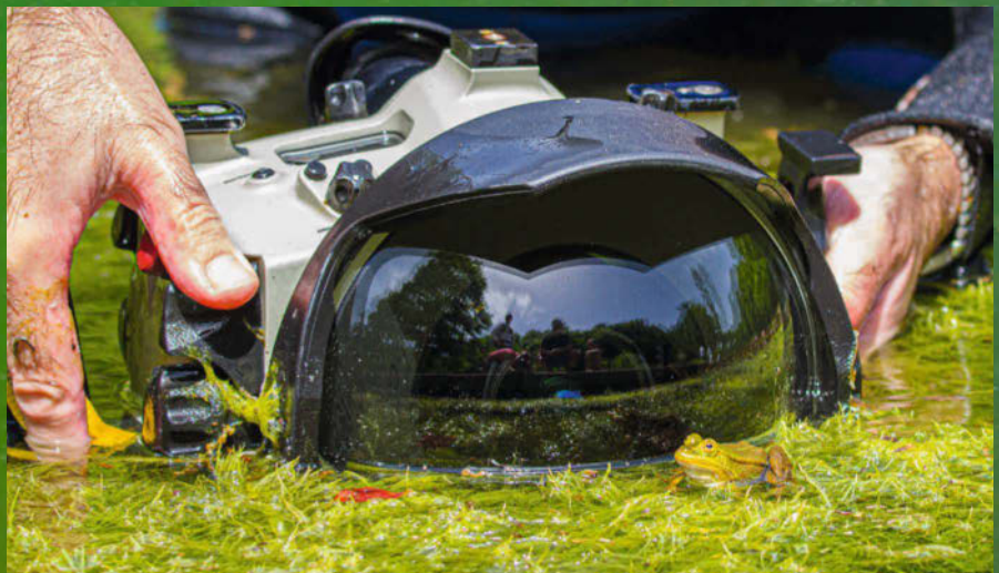
Der Domeport korrigiert den Vergrößerungseffekt des Wassers.
